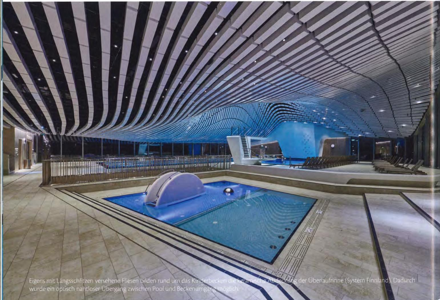
Eigens mit Längsschlitzern versehene Fliesen bilden rund um das Kinderbecken die keramische Abdeckung der Überlaufrinne (System Finnland). Dadurch wurde ein optisch nahtloser Übergang zwischen Pool und Beckenumgang möglich.
