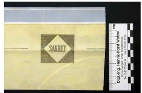
Abb. 53: Dichtband aktueller Bausätze von AIV mit zusätzlichem Butylklebestreifen zur Fixierung des Dichtbandes am Wannenrand
