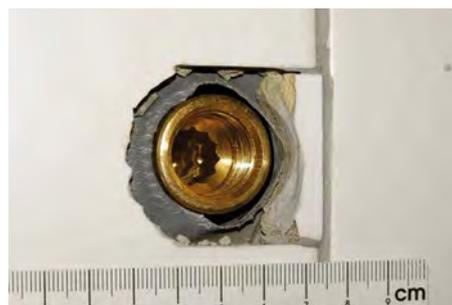
Abb. 33: Aufgrund des Kunststoff-Baustopfens überdehnte Dichtmanschette und zu später Einbau der deutlich kleineren Rohrverlängerung
