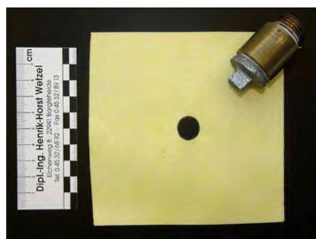
Abb. 31: Dehnfähige Dichtmanschette aktueller Bausätze von Verbundabdichtungen
