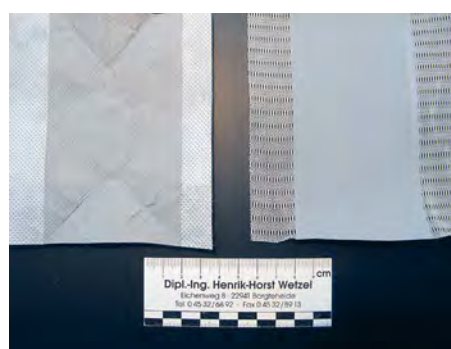
Abb. 16: Dichtband mit außenliegenden Geweberändern zur Einbettung in die AIV
