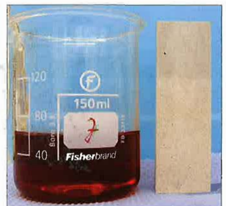
■ Einlagerungsversuche mit Prüfkörpern auf Epoxidharzbasis und verschiedenen Reinigungsmitteln; Fotos: Dr. Nüsken Chemie, Kamen
