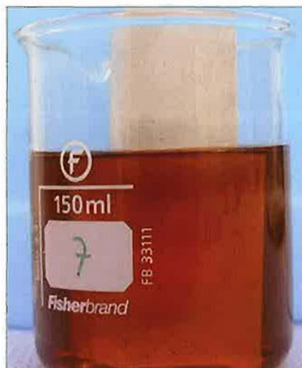
■ Einlagerungsversuche mit Prüfkörpern auf Epoxidharzbasis und verschiedenen Reinigungsmitteln; Fotos: Dr. Nüsken Chemie, Kamen
