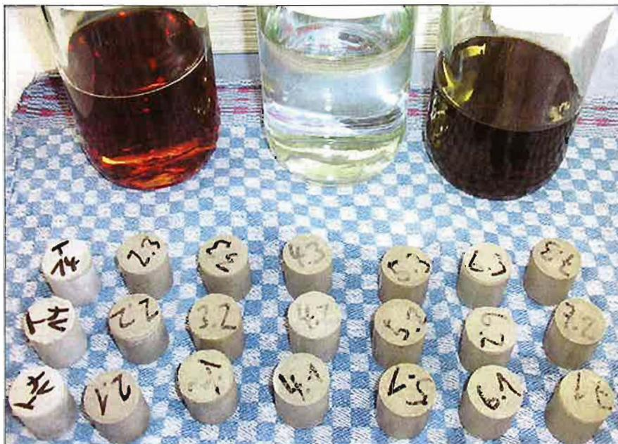
■ Prüfkörper nach Einlagerungsversuchen; Foto: Säurefließner-Vereinigung, Großburgwedel
