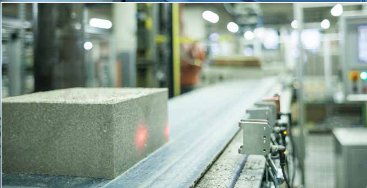
Optoelektronische Maßkontrolle in der keramischen Steinproduktion – damit es nachher passt.
